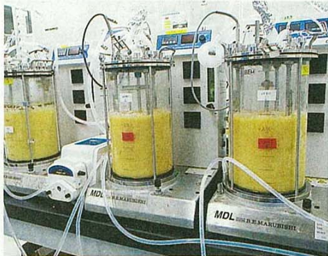
①ミドリムシの顕微鏡写真。ぎっしり詰まった粒子がパラミロンだ ②培養実験の様子。よく攪拌(かくはん)して酸素や栄養分を行き渡らせる ＝ともに神鋼環境ソリューション提供
